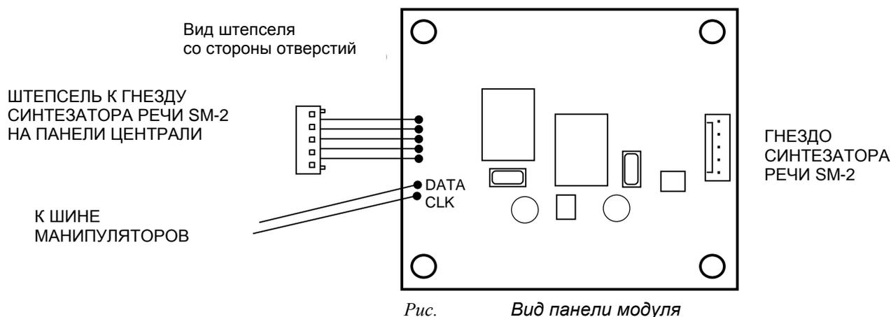
Модуль допускается застроить в корпус централи.
