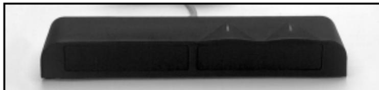
•Il LED rimane acceso per 20 secondi al massimo nella fase di attivazione. Si consiglia di non provocare alcuna rilevazione in questo lasso di tempo. Poi, la spia LED si accende quando il rilevatore sta operando.
