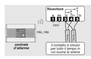
Attenzione: se si desidera il report ON / OFF e il report d'allarme, bisogna necessariamente allocare un relé diverso a ogni singola funzione.
