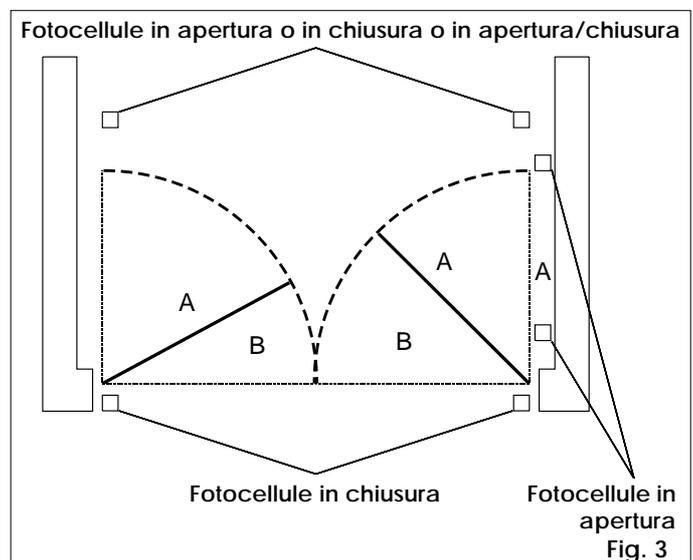
che in presenza di un ostacolo nell'area protetta dalle sicurezze intervengono, interrompendo il movimento delle ante del cancello (fig. 3).
