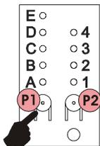
Die Taste P1 erneut drücken, um die Funktion zu beenden (alle LED ausgeschaltet). Mit der Funksteuerung einen Impuls geben, um das Tor zu schließen.
