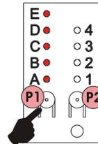
Nach der Einstellung der Geschwindigkeit schalten sich durch Drücken der Taste P1 alle 5 LED von A bis E ein.
