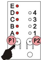
Durch erneutes Drücken der Taste P1 schalten sich alle 5 LED von A bis E ein. (Sicherstellen, dass das Tor geschlossen und die Antriebe verriegelt sind).
