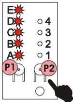
Wenn die Taste P2 1 Sekunde lang gedrückt wird, beginnen der MASTER-B7- und der SLAVE-B7-Flügel, sich gemeinsam bis zum mechanischen Öffnungsanschlag zu bewegen. Während dieser Phase blinken die 5 LED. Nach dem Lernverfahren leuchten die 5 LED im Dauerlicht auf.
