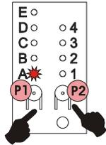
Wenn alle LED ausgeschaltet sind, müssen zuerst die Taste P1 anhaltend und dann die Taste P2 gedrückt werden. Die LED A beginnt zu blinken.
