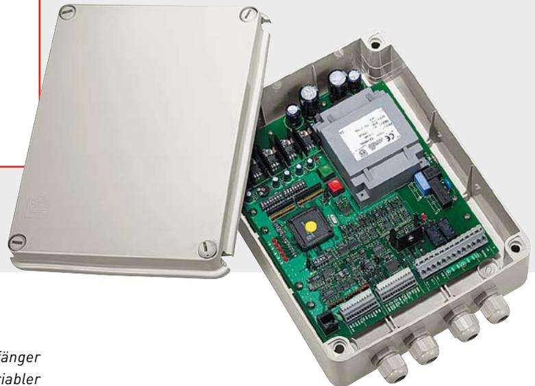
*DTRXDC ist ein mikroprozessorgesteuerter Digitalempfänger zur Fernbedienung von Schwenk-Neige-Köpfen mit variabler Geschwindigkeit (PTH355P) und motorisierten Optiken.*
