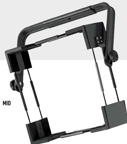
**MHSW1** • Supporto a muro, in tubo di alluminio con piatto in acciaio, verniciato a polveri di epossipoliestere colore grigio scuro. I monitor devono essere adatti al fissaggio tramite viti alla base del supporto. Indicato per monitor di piccole dimensioni: 9"-12"-14".
