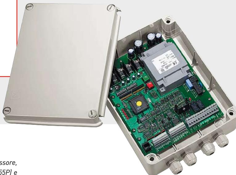
Il DTRXDC è un ricevitore digitale, controllato da microprocessore, per il controllo remoto di brandeggi a velocità variabile (PTH355P) e di ottiche motorizzate.
