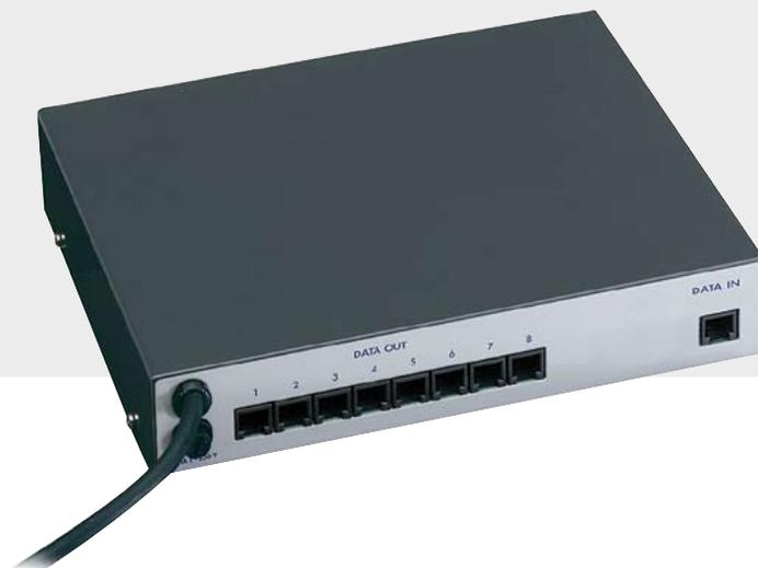
Il DCRE485 è un distributore di dati seriali il cui impiego è suggerito nel caso in cui si vogliano aumentare le linee di ricevitori DTRX3, DTRXDC, DTMRX2 e MICRODEC485. L'apparecchio restituisce i dati seriali contemporaneamente su 8 uscite, permettendo così di effettuare configurazioni a stella del sistema.
