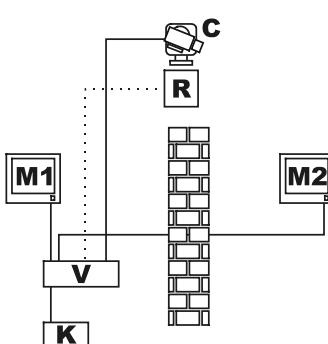
In diesem Beispiel ist M1 der *Master-Monitor*, M2 der *öffentliche Monitor*. Die Schwenk-Neige-Kamera C erfaßt den öffentlichen Monitor.
