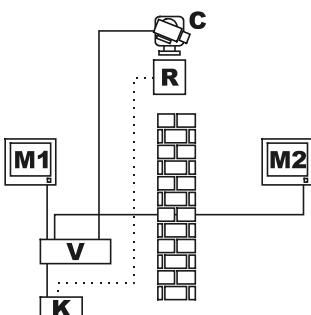
Sur cet exemple, le pupitre K contrôle directement le récepteur R pour les mouvements de la caméra C.
