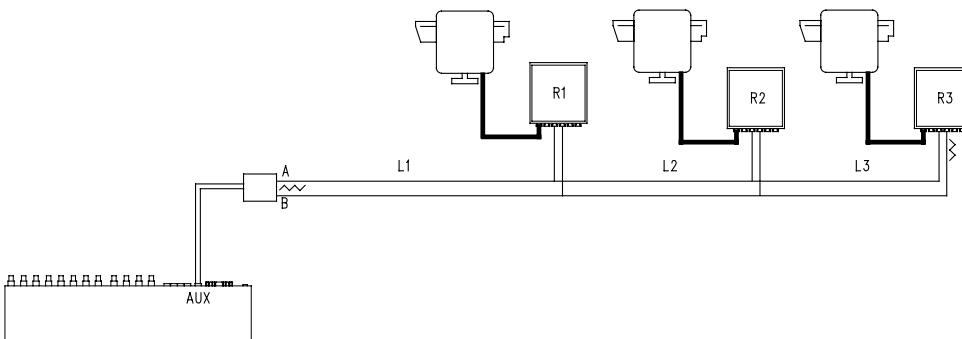
Bei den Empfängern R1, R2 darf der Abschlußwiderstand nicht eingeschaltet sein. Die Höchstlänge der Leitung von einem zum anderen Ende (von der AUX Matrix- Leitung zum Empfänger R3) beträgt 1200 Meter.
