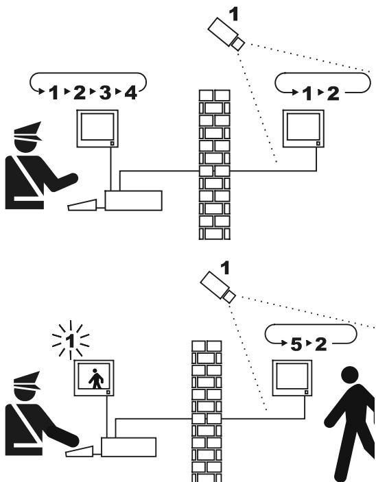
Im Beispiel zeigt der Master-Monitor eine Umschaltsequenz an den Eingängen 1, 2, 3 und 4. Der öffentliche Monitor zeigt die Eingänge 1 und 2. Die Kamera 1 erfaßt den Bereich einschließlich des öffentlichen Monitors.
