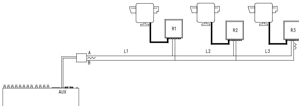
I ricevitori R1, R2 non devono avere la resistenza di terminazione inserita. La lunghezza massima della linea, da capo a capo (dalla matrice al ricevitore R3), è di 1200 metri.
