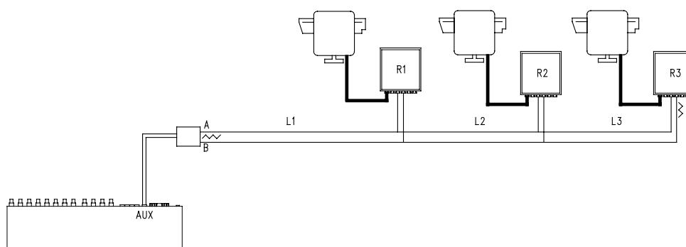
La résistance de terminaison des récepteurs R1, R2 ne doit pas être introduite. La longueur maximale de la ligne d'une extrémité à l'autre (de la ligne AUX matrice au récepteur R3) est de 1200 mètres.
