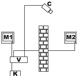
In diesem Beispiel ist M1 der *Master-Monitor*, M2 der *öffentliche Monitor*. Die Festkamera C erfaßt den öffentlichen Monitor.
