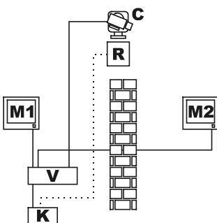
Sur cet exemple, le pupitre K contrôle directement le récepteur R pour les mouvements de la caméra C.
