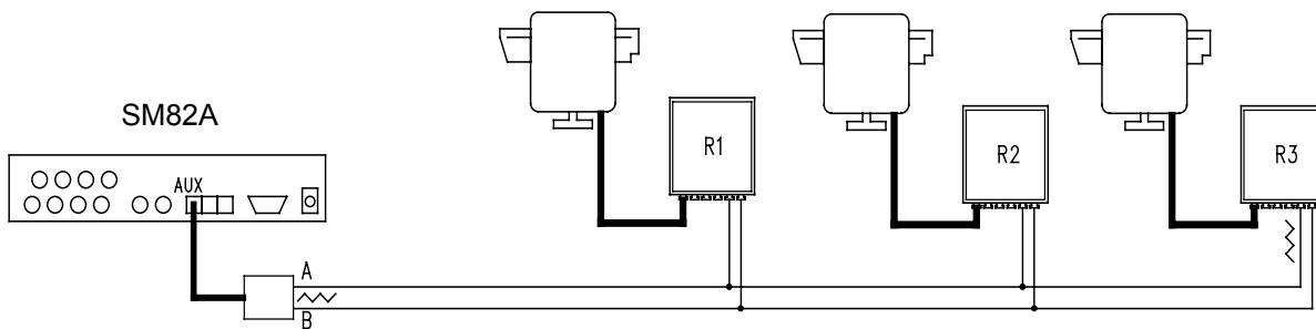
I ricevitori R1, R2 non devono avere la resistenza di terminazione inserita. La lunghezza massima della linea, da capo a capo (dalla linea AUX matrice al ricevitore R3), è di 1200 metri.
