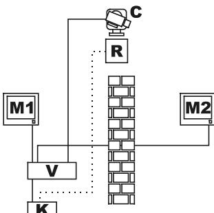
In questo esempio la tastiera K controlla direttamente il ricevitore R per muovere la camera C.
