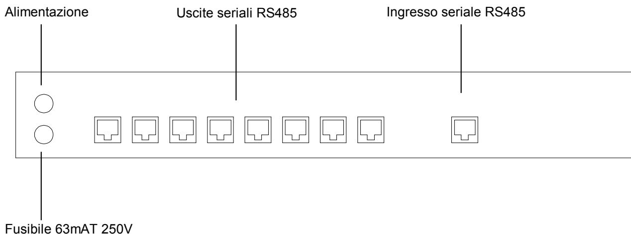
Per il collegamento con il cavo twistato, collegare gli apparecchi tramite le scatole di derivazione RJ, fornite dal fabbricante, secondo le tabelle di riferimento riportate di seguito:
