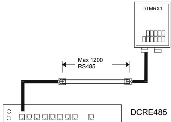
Für den Anschluß an dem Empfängersklemmenbrett auf die entsprechenden Bedienungshandbücher sich beziehen.
