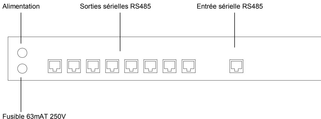
Pour le raccordement avec boucle, raccorder les appareils au moyen des boîtes de dérivation RJ, fournies par le fabricant, suivant les tableaux de référence ci-dessous:
