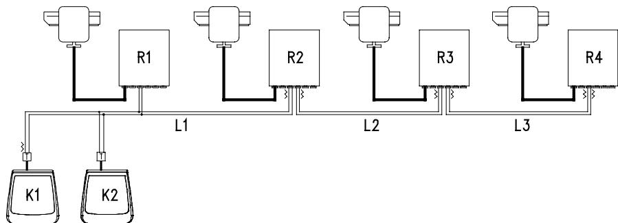
Im obigen Beispiel hat ein Ausfall des Empfängers R1 (Mehrpunkt-Anschluß an Leitung L1) keine negativen Auswirkungen auf den Empfänger R2. R1 befindet sich nicht am Ende der Leitung L1, braucht also nicht abgeschlossen werden. Sollte der Empfänger R2 ausfallen, mithin der "Generator" der Leitung L2, können sämtliche mit ihm in Kaskade geschalteten Empfänger (in diesem Fall R3 und R4) keine Befehle mehr empfangen.
