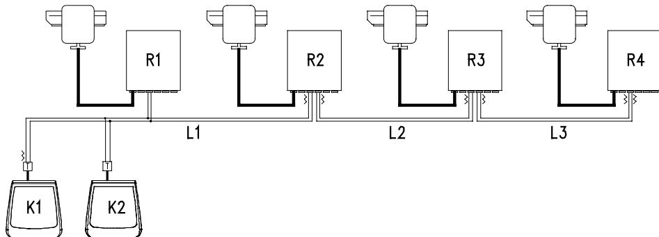
Sur l'exemple, le blocage éventuel du récepteur R1 (connecté en multipoint sur la ligne L1) n'entraîne pas le dysfonctionnement du récepteur R2. R1 ne se trouve pas aux extrémités de la ligne L1 et ne doit donc pas être terminé. En cas de blocage du récepteur R2, ce dernier étant le "générateur" de la ligne L2, tous les récepteurs connectés à ce dernier en cascade (R3 et R4) cesseront de recevoir les commandes.
