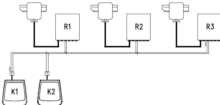
An den Endpunkten (Tastatur K1-Empfänger R3) muß der Abschlußwiderstand eingeschaltet sein. Bei den Empfängern R1, R2 und der Tastatur K2 darf hingegen der Abschlußwiderstand nicht eingeschaltet sein. Die Höchstlänge der Leitung von einem zum anderen Ende (von der Tastatur K1 bis zum Empfänger R3) beträgt 1200 Meter.
