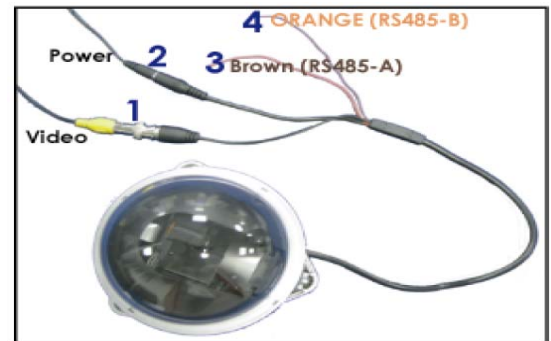
5. ábra: Példa RS485 A/B vezeték csatlakoztatására
