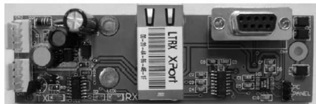
J-NET-INT-TCP/IP TCP/IP KOMMUNIKÁCIÓS INTERFÉSZ
