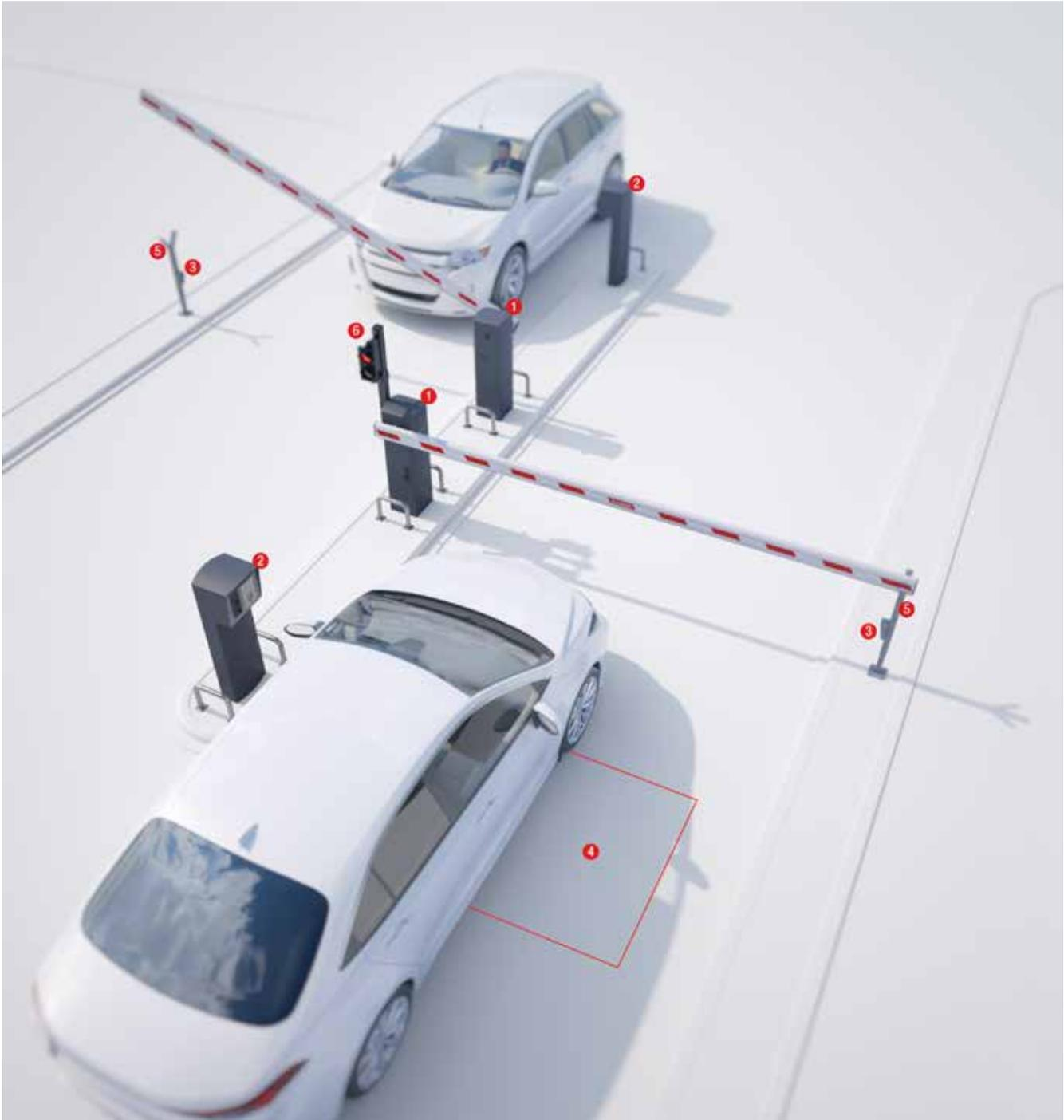
1. Schrankengehäuse mit integrierter Steuerung
