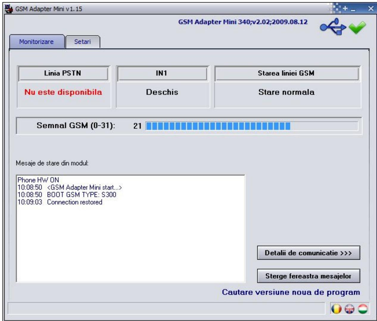
Dupa stabilirea cu succes a conexiunii, va fi accesibila monitorizarea starii modulului in fereastra „**Monitorizare**”, unde se poate verifica linia de telefon PSTN, starea intrarii, starea liniei GSM si intensitatea semnalului, precum si se pot urmari mesajele modulului.
