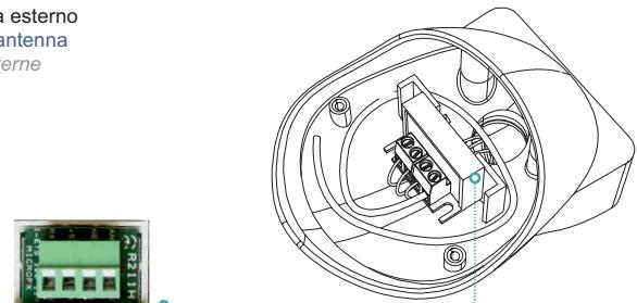
possibile installazione del ricevitore radio all'interno del lampeggiatore
