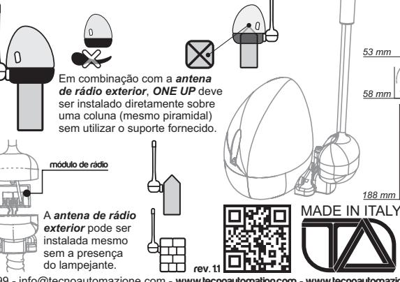
Em combinação com a **antena de rádio exterior**, **ONE UP** deve ser instalado diretamente sobre uma coluna (mesmo piramidal) sem utilizar o suporte fornecido.
