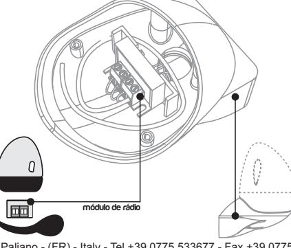
**ONE UP** se puede instalar en combinación con la antena de radio exterior cod. RANRC5T (si está disponible). Esta operación puede aumentar considerablemente el alcance de la señal.
