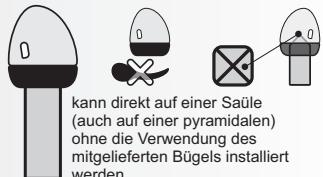
kann direkt auf einer Säule (auch auf einer pyramidalen) ohne die Verwendung des mitgelieferten Bügels installiert werden.
