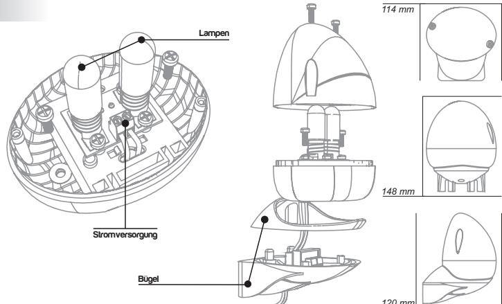
Der mitgelieferte Bügel der Blinkleuchte **ONE UP** ermöglicht eine Installation des **Funkmoduls** cod. RADCN4T (falls verfügbar) in seinem Inneren. Diese Operation kann die Reichweite des Funksignals erheblich erhöhen.
