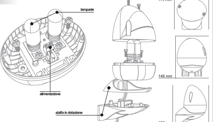
La staffa in dotazione del lampeggiatore **ONE UP** offre la possibilità di ospitare al suo interno il **modulo radio** cod. RADCN4T (se disponibile). Questa operazione può aumentare in maniera considerevole la portata del segnale.
