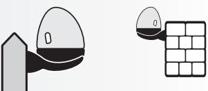
Se puede instalar en una pared usando el soporte y los tornillos suministrados.
