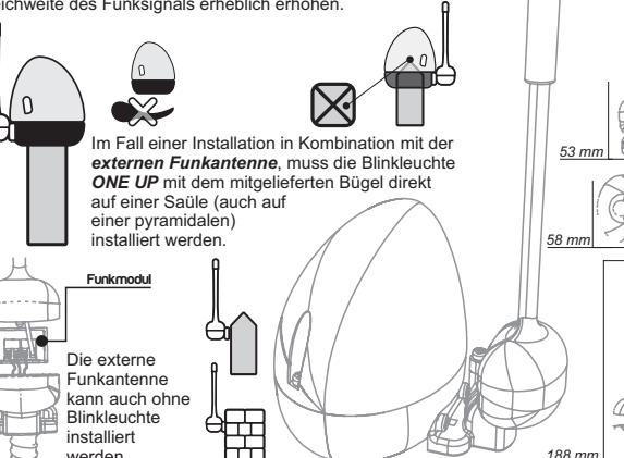
Im Fall einer Installation in Kombination mit der **externen Funkantenne**, muss die Blinkleuchte **ONE UP** mit dem mitgelieferten Bügel direkt auf einer Säule (auch auf einer pyramidalen) installiert werden.
