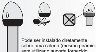
Pode ser instalado diretamente sobre uma coluna (mesmo piramidal) sem utilizar o suporte fornecido.
