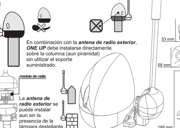
En combinación con la **antena de radio exterior**, **ONE UP** debe instalarse directamente sobre la columna (aun piramidal) sin utilizar el soporte suministrado.
