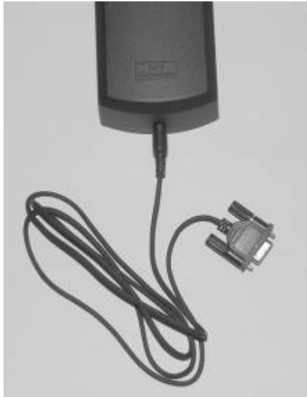
그림 4> 스테레오 플러그를 DB-9 케이블에 연결하기
