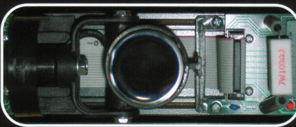
Di serie è dotata del dispositivo di termostatazione automatica efficace in caso di condensa e gelo.
