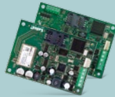
GSM LT-1 / GSM LT-2 Telefonvonalpótló GSM modul
