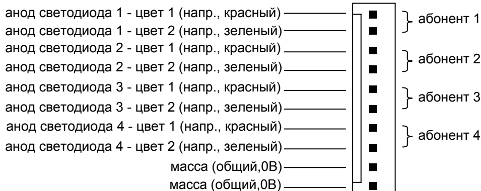
Рис. 6. Способ подключения диодов LED к контактам гнезда J1 панели в случае взаимодействия со станцией мониторинга STAM-1.
