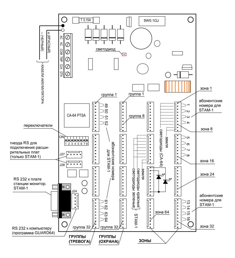
Рис. 1. - Расположение элементов на плате синоптического табло в версии CA64T V1.4.
