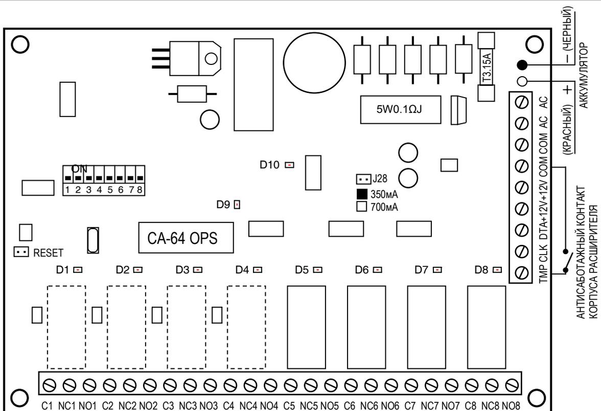
Рис. № 1. Вид платы расширителя в исполнении „ROC” (4 выхода типа OC плюс 4 релейных выхода)
