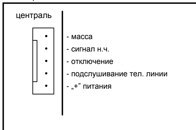
Рис. № 23. Распределение сигналов по разъемам синтезатора речевого оповещения SM-2.
