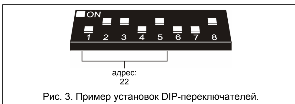
Рис. 2. Пример установок DIP-переключателей.
