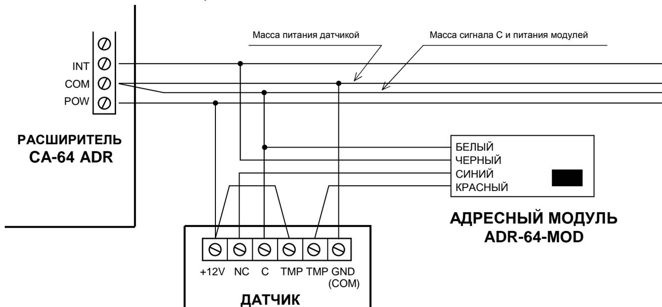
Наибольшее допустимое расстояние между датчиком и расширителем CA-64 ADR составляет 1000 м. Электропитание датчиком вместе с модулями должно осуществляться с выхода POW расширителя. «Масса датчиком **GND**» и «общая масса сигнала **C** и питания адресного модуля» должны быть подключены отдельными проводами (см. схемы).
