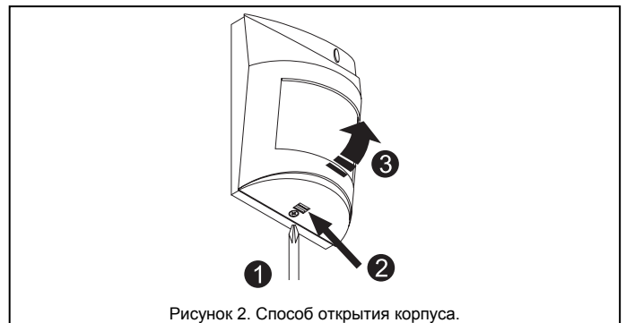
Рисунок 2. Способ открытия корпуса.
