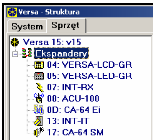
Rys. 12. Lista urządzeń podłączonych do centrali wyświetlana w zakładce „Sprzęt” w oknie „Versa – Struktura” (przykładowa konfiguracja).
