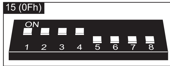
Rys. 20. Sposób ustawienia adresu w ekspanderze wyjść.
