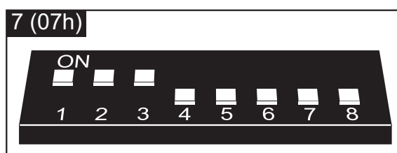
Rys. 13. Sposób ustawienia adresu w ekspanderze INT-RX.
