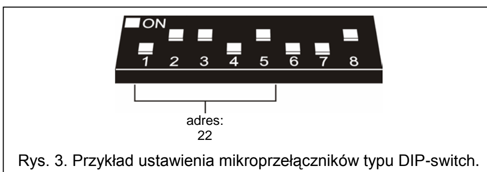
Rys. 2. Przykład ustawienia mikroprzełączników typu DIP-switch.
