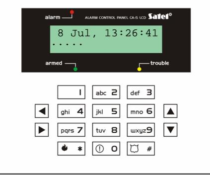
Fig. 2. CA-5 LCD keypad
