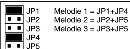
Abb. 2. Position der Steckbrücken
