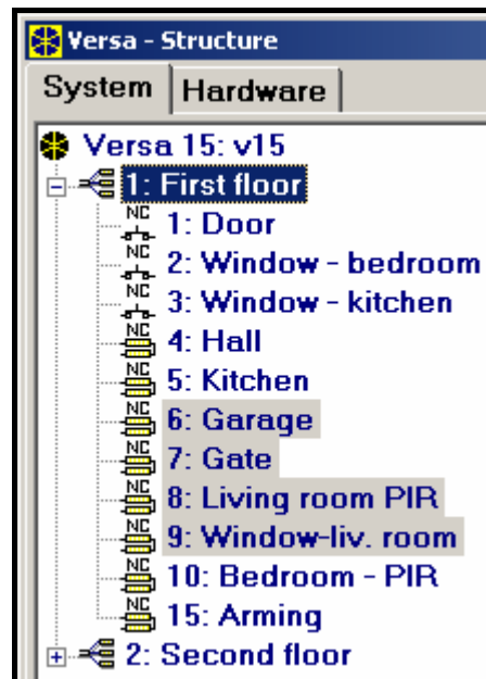
6. ábra Partíciók és zónák listája fa struktúrában a "Rendszer" menüben, a "Versa – Szerkezet" ablakban (példa konfiguráció).
