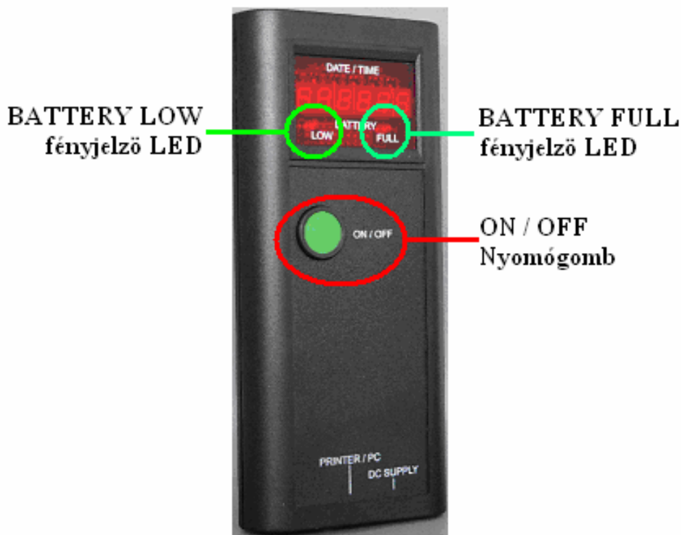
6. Ábra Az akkumulátor állapotát jelző LEDEK
