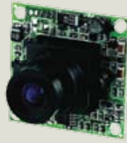
PAL: CCD-SONY 639BK DSP-SONY 3172R NTSC: CCD-SONY 638BK DSP-SONY 3172R
