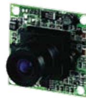
PAL: CCD-SONY 227 DSP-SONY 3142 NTSC: CCD-SONY 226 DSP-SONY 3142
