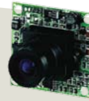
PAL: CCD-SONY 227 DSP-SONY 3142 NTSC: CCD-SONY 226 DSP-SONY 3142
