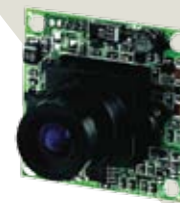
PAL: CCD-SONY 643 DSP-SONY 3142 NTSC: CCD-SONY 642 DSP-SONY 3142
