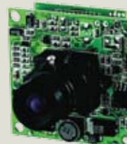
PAL: CCD-SONY 639BK DSP-SONY 3172R NTSC: CCD-SONY 638BK DSP-SONY 3172R
