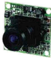
PAL: CCD-SONY 405AK DSP-SONY 3142R NTSC: CCD-SONY 404AK DSP-SONY 3142R
