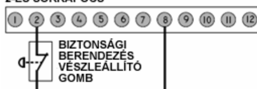
4 VÉSZLEÁLLÍTÓ GOMB ALAPESETBEN ZÁRT KONTAKTUS (NC) 2-ES SORKAPOCS
