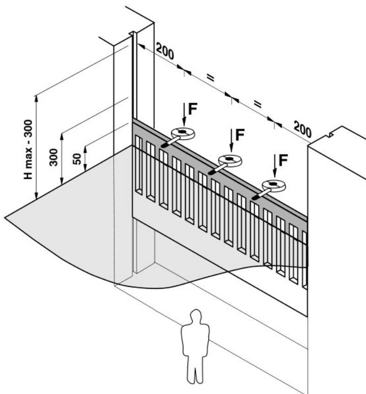
Nel grafico sono indicati i valori massimi delle forze operative dinamiche, statiche e residue, in relazione alle diverse posizioni dell'anta.
