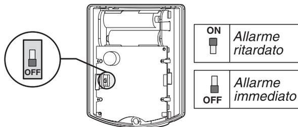
Tramite il commutatore selezionare il tipo di modalità prescelta per far scattare l'allarme (default: immediato).
