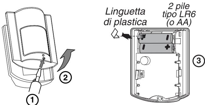
**Il buzzer del sensore deve emettere 2 bip, altrimenti verificare la polarità delle pile.**
