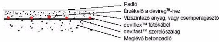
Felújított padló meglévő betonpadlón – száraz helyiségben
