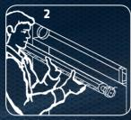
Insérer le moteur dans l'axe et le fixer au palier mural
