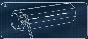
Régler les points de démarrage et d'arrêt pour « Ouvrir » et « Fermer »
