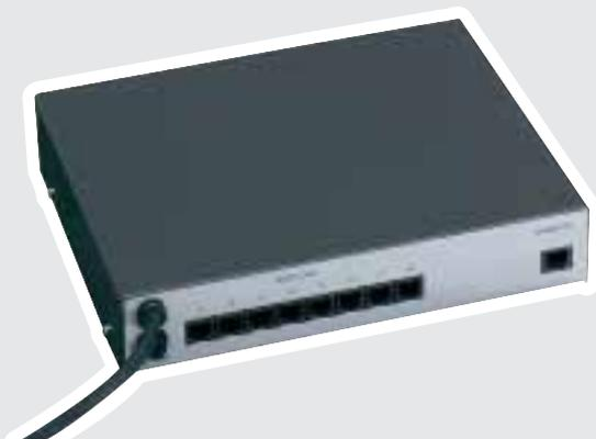
El par transmisor receptor de vídeo mediante línea bifilar constituye una interesante solución para todos los problemas de instalación en los que la distancia que la señal vídeo debe recorrer por cable es grande. El receptor está disponible tanto en caja estanca como en tarjeta standard Europa. Los distribuidores de señales vídeo son disponibles en versiones con 1, 4, 8 entradas y 8, 16 salidas según las exigencias de la instalación.
