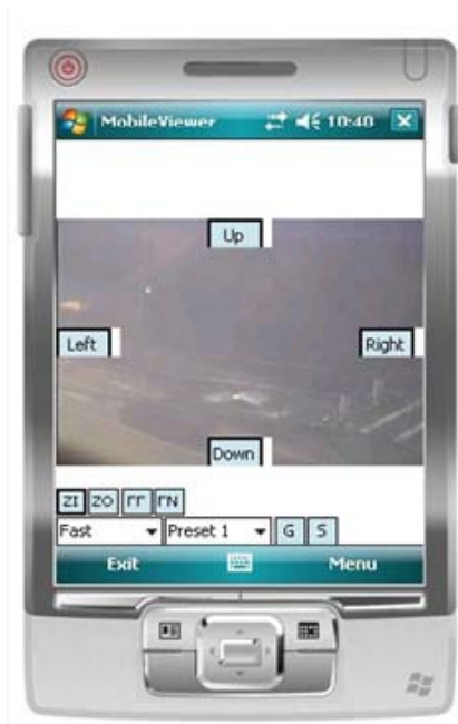
4.86. ábra PTZ vezérlés képernyő.
