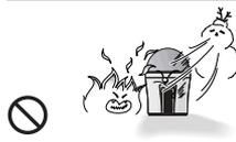
N'employez pas l'appareil sous les températures extrêmes (au-dessous de -10° ou au-dessus de +50°). Cela peut causer une pauvre qualité de l'image ou une détérioration. Faites attention particulièrement à ventiler quand l'appareil est utilisé sous des températures élevées.
