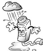
Asciugare qualunque liquido. Essi contengono minerali corrosivi per i componenti elettronici.
