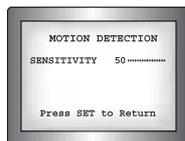
2. Aumentare o diminuire la sensibilità del Motion detection, impostando un valore a 'SENSITIVITY'.
