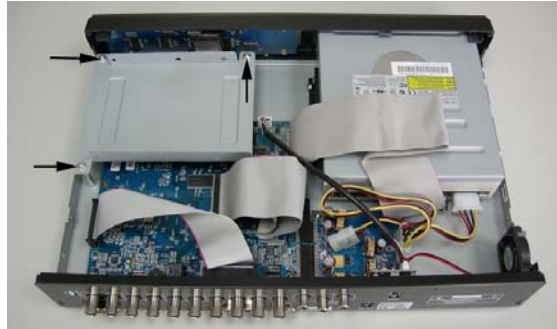
2. lépés: HDD tartó eltávolítása
