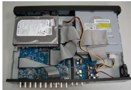
4. lépés: A HDD tartó visszahelyezése a DVR-be.
