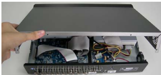
5. lépés: A DVR fedelének visszahelyezése
