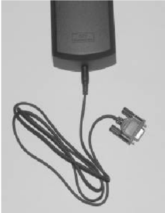
4. ábra > A sztereo jackdugó és a DB-9 kábel csatlakoztatása
