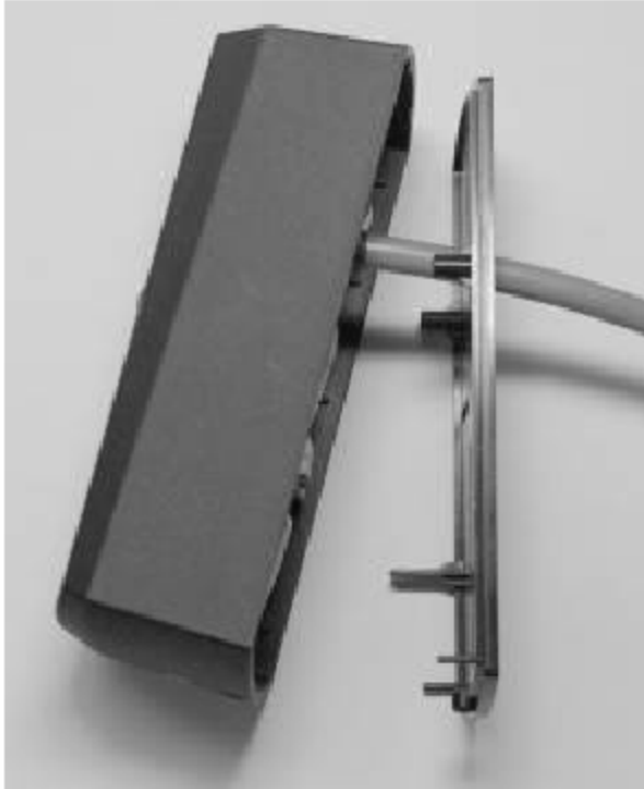
8. ábra > A készülék fedelének eltávolítása
